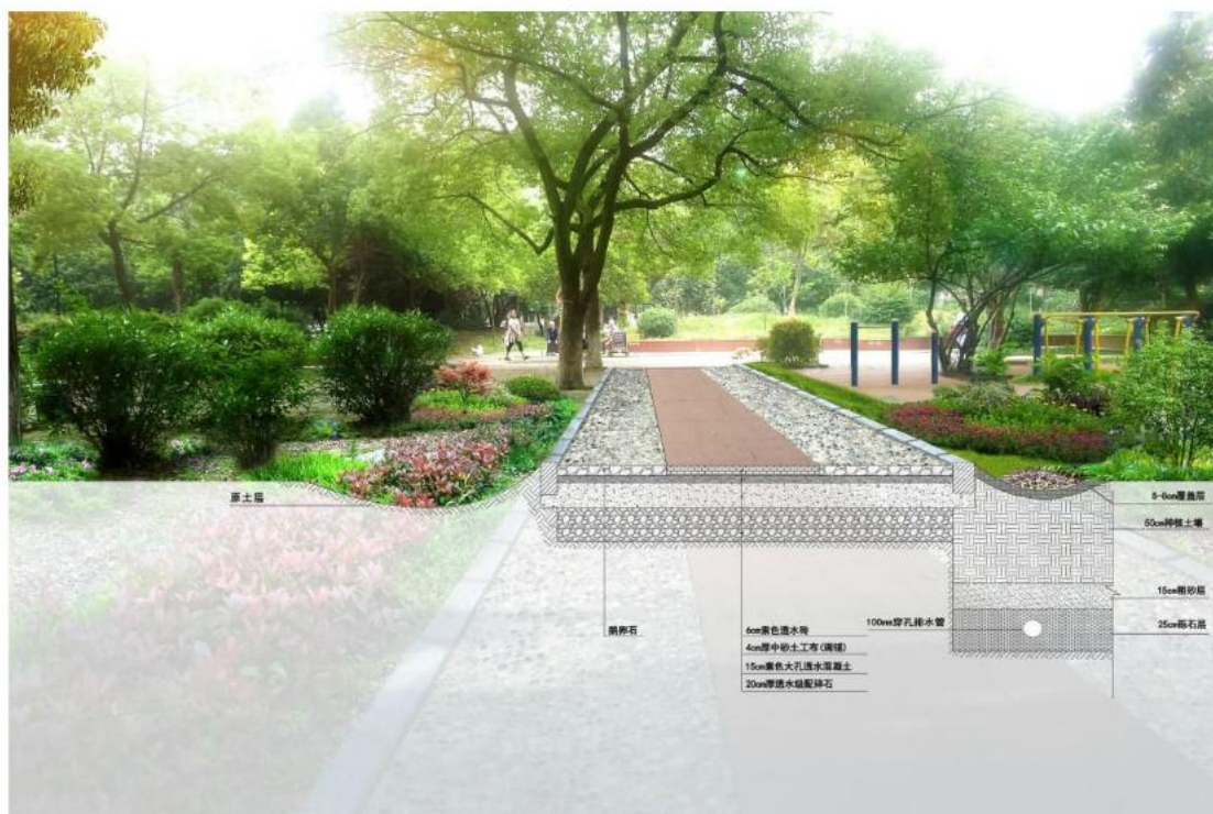
图 8.5.4（1）-1 透水铺装及两侧植草沟实景图（一）
