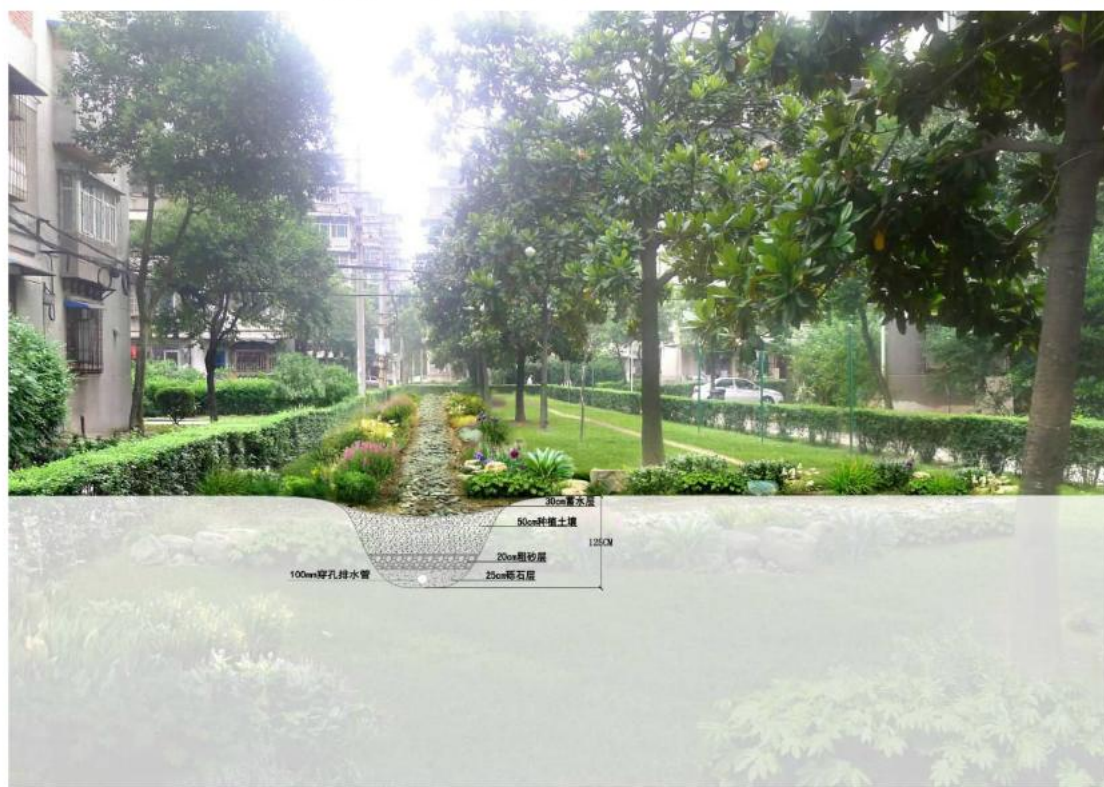
图 8.5.1 (3) -3 生物滞留设施剖面图
