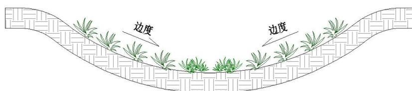
图 D.6-1 输水型植草沟示意图
